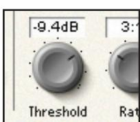
La commande Threshold règle le niveau seuil minimum que doit atteindre le signal audio entrant pour faire entrer en service le compresseur.
