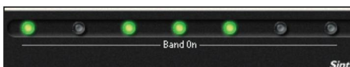
Presser un bouton Band On active la bande correspondante. Chaque bande a son propre commutateur Band On, situé sous les boutons correspondants de gain, fréquence et Q de la bande.
