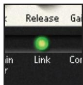
Ce commutateur de couplage permet de compresser identiquement les canaux gauche et droit par couplage de leurs circuits de déclenchement ou "sidechains" (voir ci-dessous la note sur les sidechains), lors de la compression d'un signal stéréo. Ce commutateur sera activé par défaut à l'ouverture d'une occurrence stéréo de Liquid Mix.
